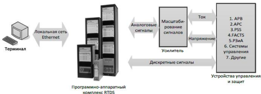
Р и с у н о к 1 – Схема подключения к RTDS внешних устройств
