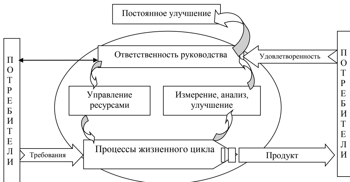
Р и с у н о к 3 – Процессная модель системы менеджмента качества организации в соответствии с требованиями ГОСТ Р ИСО 9001-2008
