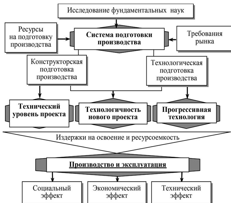
**Рисунок 2 – Влияние системы подготовки производства на эффективность запуска нового проекта**
