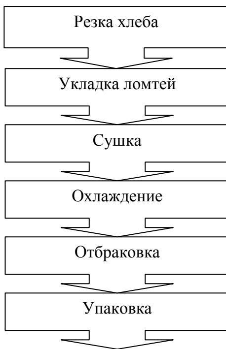
Р и с у н о к 1 Принципиальная схема технологического процесса переработки черствого хлеба на сухари в ОАО «Хлебозавод»
